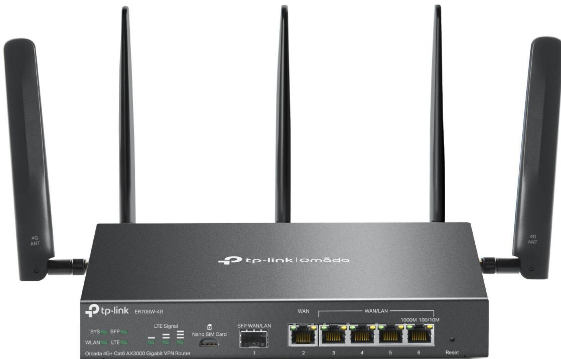
ER706W-4G je prvním routerem z rodiny Omada SDN se slotem na Nano SIM kartu pro LTE/4G+ připojení k mobilnímu internetu, s rychlosť stahování až 300 Mb/s a uplinkem až 50 Mb/s
